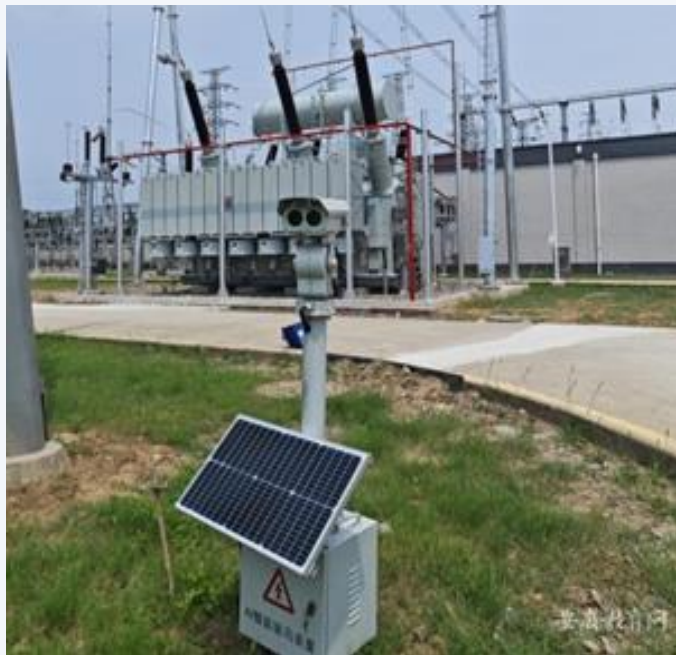
图 2-10 学院研发的一款融合尖端 AI 大模型技术的升级版激光驱鸟装置
